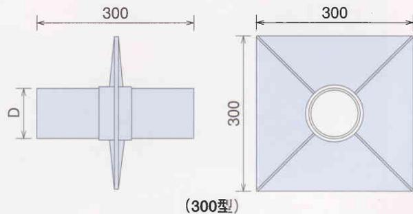
**特記-1** 標準型水切り板を塩ビ管に接着剤を塗り、差し込んで取り付けて下さい。
